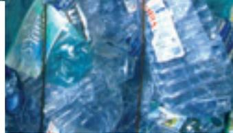
Après tri, les matériaux à recycler sont compactés en balles. Ici, les bouteilles plastiques colorées.
