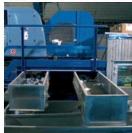
La machine "Mistral" : séparation des éléments à recycler par matière et par couleur.
